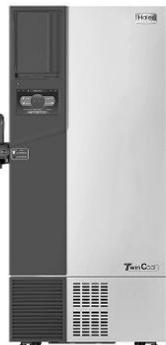
Низкотемпературный вертикальный морозильник с интеллектуальной технологией TwinCool. Климатический класс: N. Диапазон температур: от  $-40$  до  $-86$  °C. Объем камеры: 578 литров. Внутренние размеры камеры: 620x716x1310 мм. Внешние размеры: 895x998x1980 мм.
